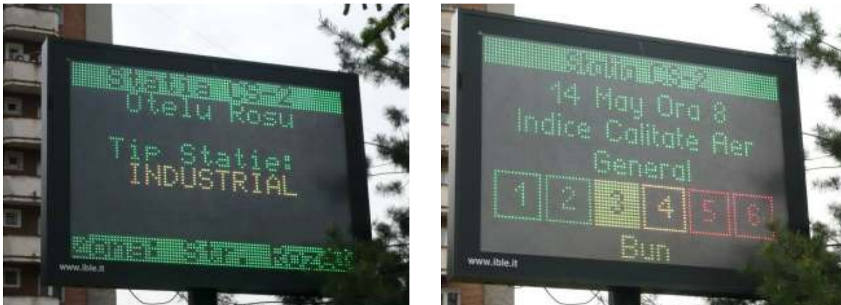
Informații referitoare la calitatea aerului pe panoul din Reșița, care conțin tipologia și adresa stației și indicele în timp real și o mențiune calitativă.
